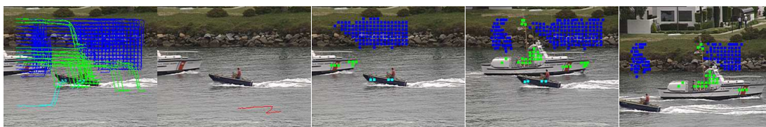
FIGURE 7.9 – Séquence Coastguarder . (de gauche à droite) Clustering automatique des trajectoires ; Trajectoires détectées comme aberrantes et rejetées ; assignation finale montrée sur les points des trajectoires présentes aux images 1, 41 et 81.
