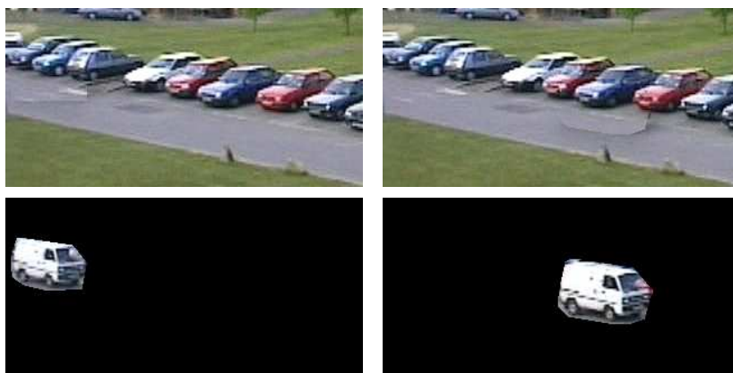
FIGURE 5.5 – Mosaïques de référence pour la séquence PETS 2001 . Ici, les mosaïques sont obtenues manuellement afin de valider le principe de segmentation basé sur le terme de mouvement d'image à mosaïque de référence (équation (4.4)). Première ligne, mosaïques du fond obtenues facilement à partir des deux images de référence, sachant que le mouvement est nul. Deuxième ligne, mosaïques de la camionnette obtenues directement à partir des cartes de segmentation fournies par l'opérateur pour les deux images de référence 701 et 760.
