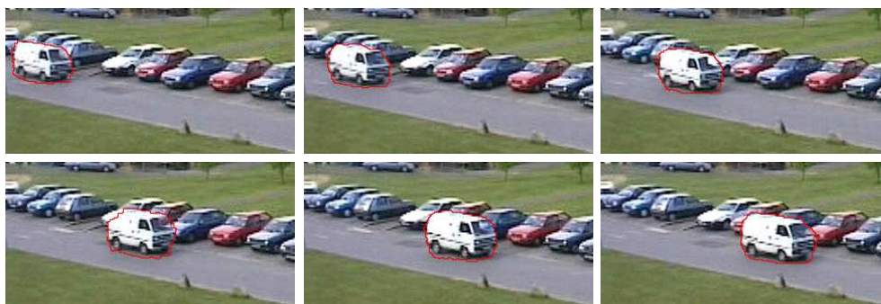
FIGURE 5.7 – Résultats de segmentation sur la séquence PETS 2001 avec contrainte temporelle. Les frontières de mouvement sont superposées sur les images originales. Seules les images 702, 710, 725, 743, 751 et 758 sont montrées. Le pare-brise de la camionnette est classé comme appartenant à l'objet d'avant-plan tout au long de l'intervalle considéré. \lambda_1 = 17 , \lambda_2 = 0 , \lambda_3 = 15 et \lambda_4 = 30 .
