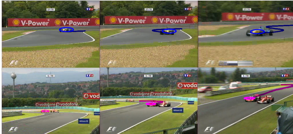
FIG. 6.1 – Images de plans vidéos filmées par deux caméras différentes dans un programme TV de Formule1 à deux endroits donnés sur le circuit. Chaque ligne de la figure présente une séquence d'image associée à un plan donné. Les trajectoires extraites par une technique de suivi sont sur imprimées sur les images.
