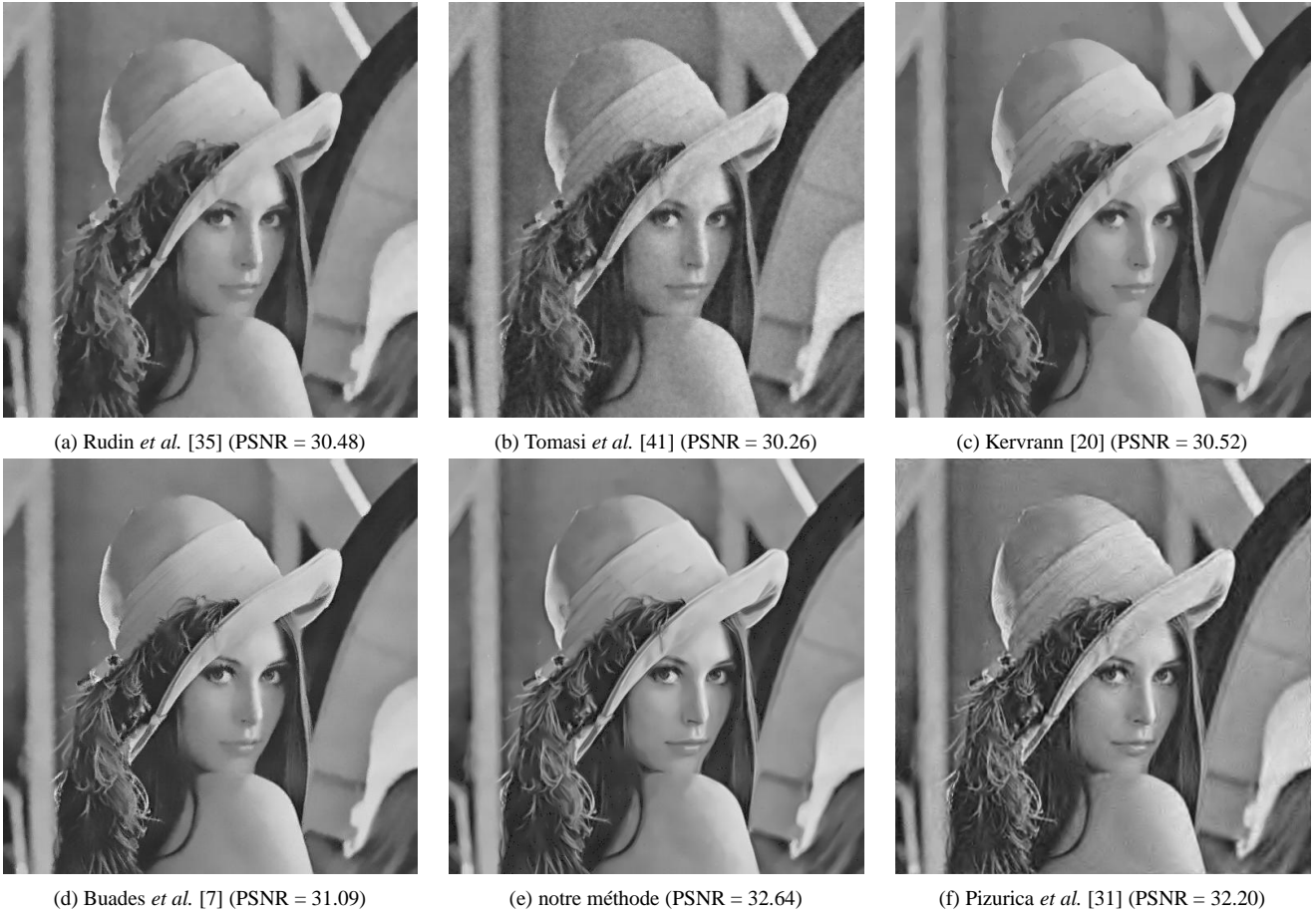
FIG. 3 – Comparaisons avec plusieurs méthodes de régularisation appliquées à l'image lena bruitée ( \sigma = 20 ).
