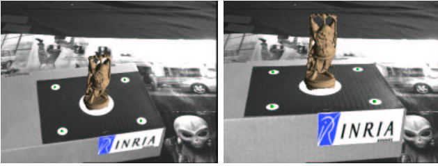
FIG. 2 – Pose à partir de point et de cercle pour une application de réalité augmentée
