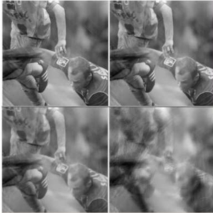
FIG. A.3: Séparation des couches transparentes par la méthode du médian appliqué aux gradients, sur une séquence synthétique de 9 images construite à partir d'images vidéo. La qualité de la compensation du mouvement de la couche stabilisée varie : elle est parfaite en haut à gauche, exacte à 1 pixel près en haut à droite, à 2 pixels près en bas à gauche et à 5 pixels près en bas à droite.
