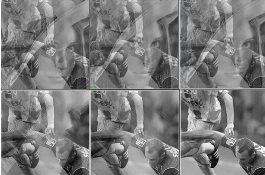
FIG. A.1: Séparation des couches transparentes sur une séquence synthétique de 9 images construite à partir d'images vidéo. En haut, les images 0, 4 et 8 de la séquence. En bas : les résultats du traitement à gauche pour le médian temporel direct, au centre pour le médian appliqué aux gradients, et à droite la vérité-terrain.
