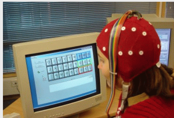
Déplacement d'un curseur sur un écran en imaginant des mouvements des mains [Pfurtscheller et al, 97]
