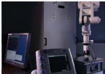
○ En pratique, ces paramètres sont estimés par une procédure de calibrage qui consiste à positionner, avec différentes orientations, le plan d'observation de la sonde sur l'intersection de deux fils de nylon croisés et immergés dans l'eau (point fixe). Un algorithme permet ensuite d'estimer les paramètres recherchés à partir des mesures des coordonnées du point dans l'image et des positions de l'effecteur.
