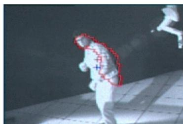
○ de contrôle des mouvements d'une caméra pour la poursuite d'objets mobiles dans le domaine de la vidéo surveillance.
