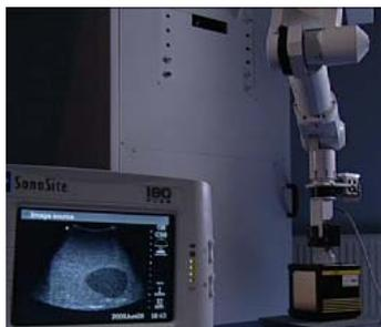
Nos travaux de recherche visent à optimiser l'acquisition échographique 3D en déplaçant automatiquement une sonde 2D à l'aide d'un robot médical. Les applications envisagées tournent autour de nouvelles fonctionnalités d'aide au clinicien (examens à distance).
