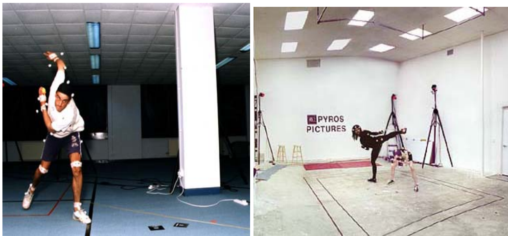
Fig. 5. Systèmes de capture du mouvement optique. A gauche les pastilles réfléchissantes sont attachées sur l'acteur, et écartées de la surface de la peau, ce qui peut permettre de réduire les occultations. A droite, elles sont collées sur une combinaison noire, ce qui gêne moins les mouvements. On peut aussi voir, sur l'image de droite, deux acteurs dont les mouvements sont capturés en même temps.
