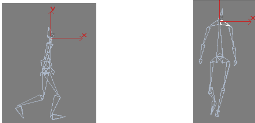
Fig. 1 Représentation d'un squelette simplifié d'un personnage animé. La structure est constituée d'un ensemble de segments, ici représenté en 3D. Pour rendre plus lisible les rotations, les os sont représentés par des octaèdres.
