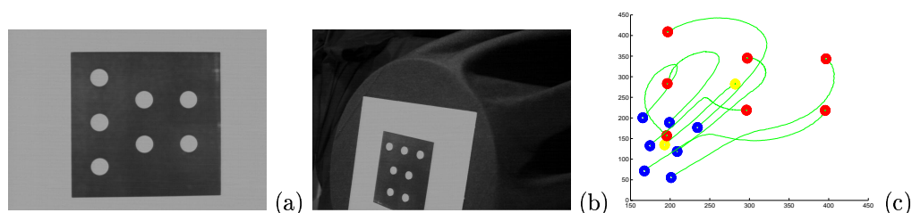
FIG. 1.10 – Positionnement pas asservissement visuel 2D 1/2: (a) image désirée, (b) image initiale, (c) trajectoire dans l'image
