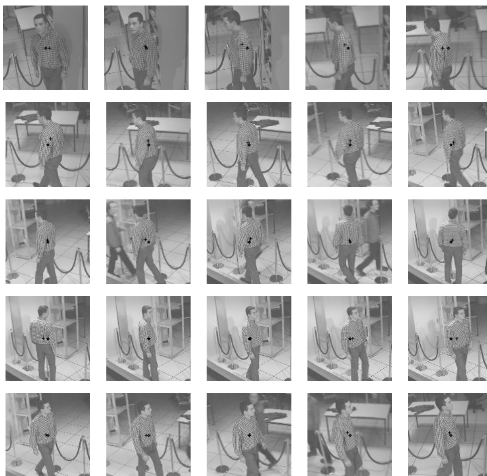
FIG. 1.13 – Suivi d'un piéton par intégration de son mouvement 2D estimé : visualisation d'une image sur dix (cadence de traitement : 25 Hz)
