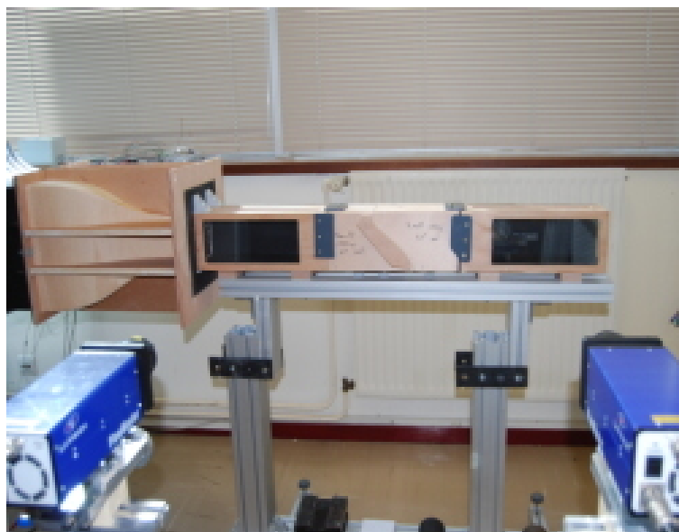
FIG. 5.3 – Vue du convergent et de la veine d'essais lors des mesures par Vélocimétrie par Imagerie de Particules.
