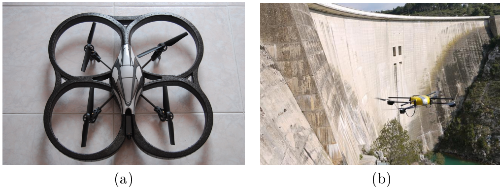
FIGURE 2.4 – Exemples de quadrirotors. (a) Le drone commercialisé par la société Parrot, (b) le drone de la société Novadem lors d'une inspection d'ouvrage d'art.
