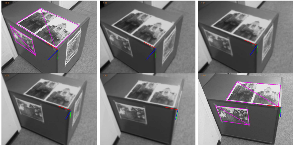
FIGURE 5.8 – Exemple de robustesse à une occlusion temporaire. La première et dernière image représente les images avant et après l’occlusion. Cette perte des mesures visuelles, provoquée par un flou et assimilable à une occlusion, dure plus de 3 secondes. Les images intermédiaires montrent que malgré la perte visuelle, la pose continue à être estimée approximativement grâce à l’utilisation des capteurs inertiels.
