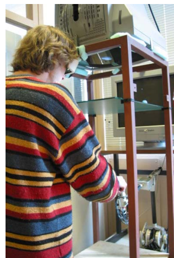
Fig. 2. Système « Fish-Tank » : un miroir est utilisé pour superposer parfaitement le retour visuel stéréoscopique d'un écran d'ordinateur et l'extrémité de l'interface haptique.
