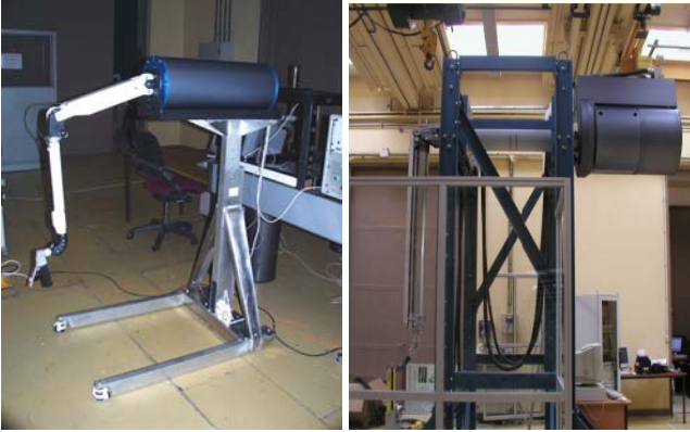
Fig. 6. Dysmorphie entre bas maître (gauche) et bras esclave MT200 numérique (droite)
