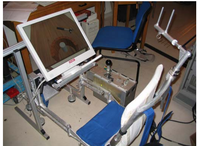
Fig. 3. Dispositif expérimental utilisé pour une tâche de décapage virtuel.
