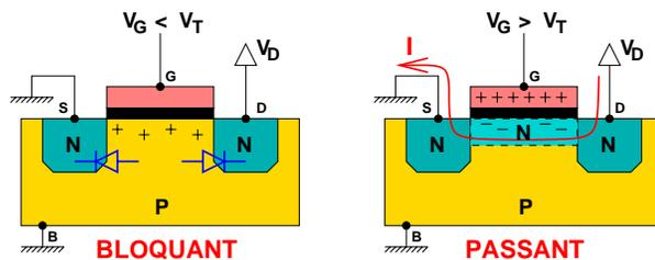
Le transistor change d'état en fonction de la tension de grille  $V_G$  (commande) par rapport à la tension de seuil  $V_T$  (cst techno) :
