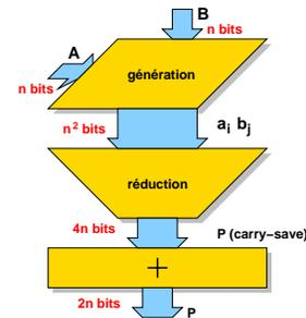
On a donc une structure permettant la multiplication en un temps de l'ordre de  $O(\log n)$ .
