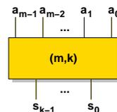
La cellule demi-additionneur (*half-adder* ou HA) est un compteur (2,2) tandis que la cellule d'addition complète (*full-adder* ou FA) est un compteur (3,2). Ces deux portes sont largement utilisées dans les opérateurs arithmétiques.
