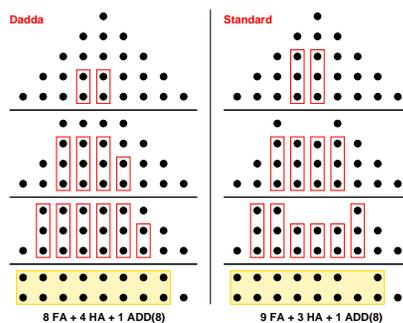
Gain en surface pour les grands multiplieurs. Exemple :  $n = 12$  bits  $\Rightarrow$  **11% de portes en moins** qu'avec un arbre de Wallace.
