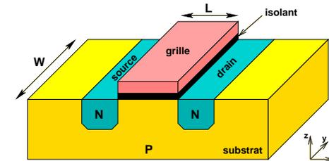
Dans une zone dopée N, les porteurs de charge majoritaires sont des électrons (ce sont des trous dans le cas d'une zone dopée P). Pour un transistor de type P on inverse les dopages.
