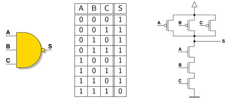
Le nombre de transistors en  **série**  dans les réseaux N et P est  **limité**  (de 3 à 5 en général). Au dessus de cette limite il faut réaliser la fonction par composition de plusieurs portes.
