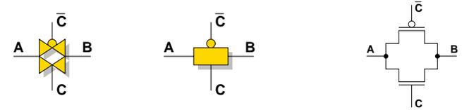
Dans une porte de transfert ou de passage (*pass gate*), les états sur les nœuds A et B ne sont pas forcés via une borne d'alimentation ( $V_{DD}$  ou  $V_{SS}$ ). Le signal se dégrade lors du passage dans une suite de telles portes (prévoir une régénération régulière).
